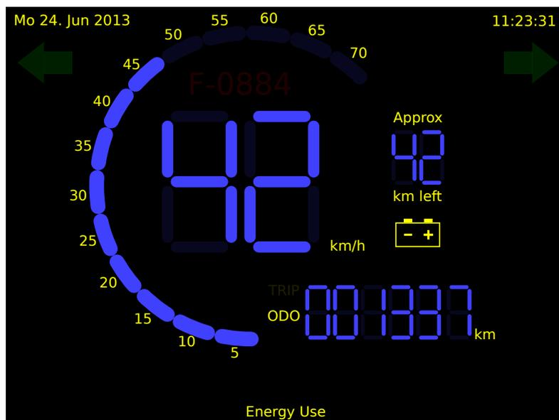
Abbildung 4.6: Entwurf der Anzeigeeinstrumente 4:3
