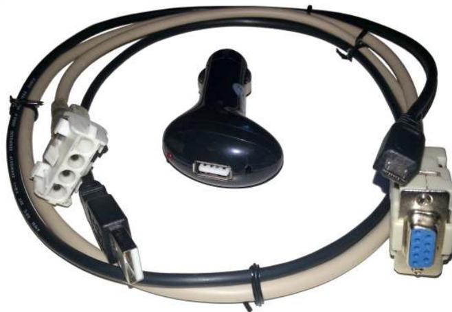
Abbildung 5.5: CAN-Bus Kabel und Spannungsversorgung
