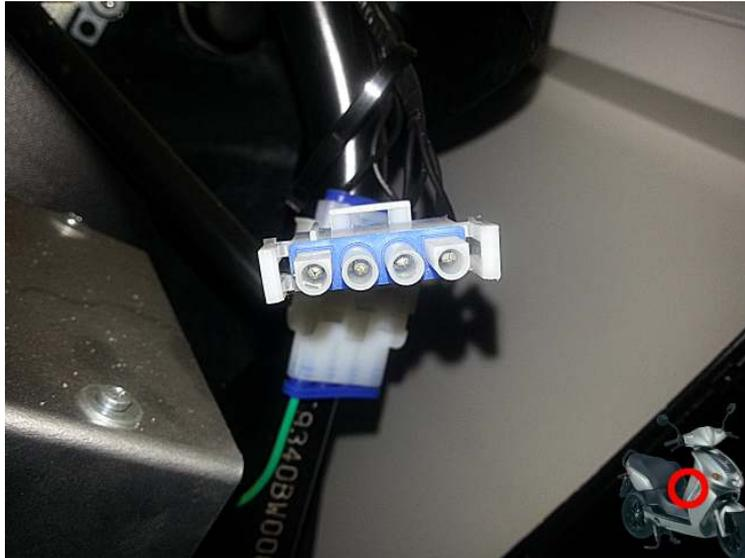
Abbildung 5.2: CAN-Bus Anschluss des Govecs GO! S1.2
