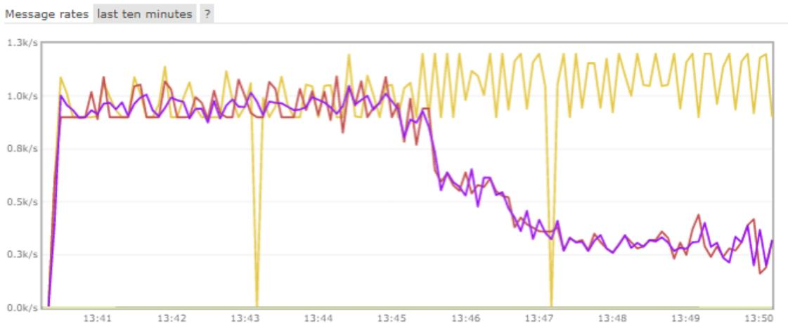
**Abbildung A.11.:** Ergebnis des Bandbreitentests für STOMP mit durchschnittlichem Nachrichtenstrom und manueller Bestätigung stellt die Nachrichtenrate des Publishers(gelb), die Bestätigungsrate des Consumers (lila), Rate des Bestätigungsversand(rot) dar. Ergebnisse über die 10 Minuten: maximale Rate von 900 Nachrichten/s, minimale Rate von 200 Nachrichten/s, durchschnittliche Rate von 658 Nachrichten/s.
