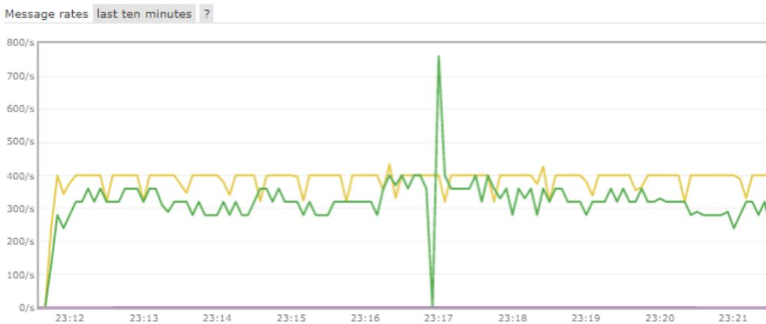
**Abbildung A.3.:** Ergebnis des Bandbreitentests für AMQP mit maximalen Nachrichtenstrom und automatischer Bestätigung stellt die Nachrichtenrate des Publishers(gelb), die Bestätigungsrate des Consumers (grün) dar. Ergebnisse über die 10 Minuten: durchschnittliche Rate von 310 Nachrichten/s.
