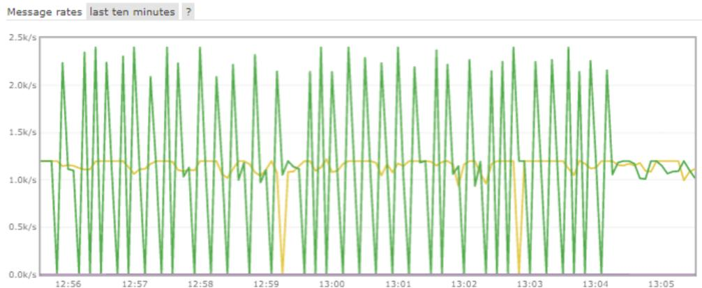
**Abbildung 4.1.:** Ergebnis des Bandbreitentests für STOMP mit heterogenem Nachrichtenstrom und automatischer Bestätigung stellt die Nachrichtenrate des Publishers(gelb) und die Bestätigungsrate des Consumers (grün) dar.
