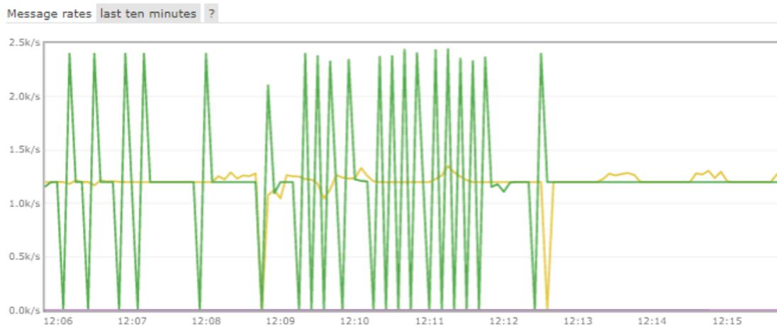
**Abbildung A.7.:** Ergebnis des Bandbreitentests für STOMP mit minimalem Nachrichtenstrom und automatischer Bestätigung stellt die Nachrichtenrate des Publishers(gelb), die Bestätigungsrate des Consumers (grün) dar. Ergebnisse über die 10 Minuten: durchschnittliche Rate von 1193 Nachrichten/s.
