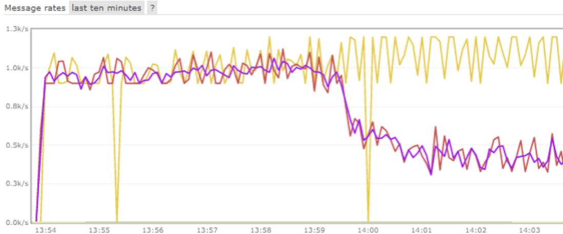
**Abbildung A.12.:** Ergebnis des Bandbreitentests für STOMP mit maximalen Nachrichtenstrom und manueller Bestätigung stellt die Nachrichtenrate des Publishers(gelb), die Bestätigungsrate des Consumers (lila), Rate des Bestätigungsversand(rot) dar. Ergebnisse über die 10 Minuten: maximale Rate von 971 Nachrichten/s, minimale Rate von 370 Nachrichten/s, durchschnittliche Rate von 700 Nachrichten/s.
