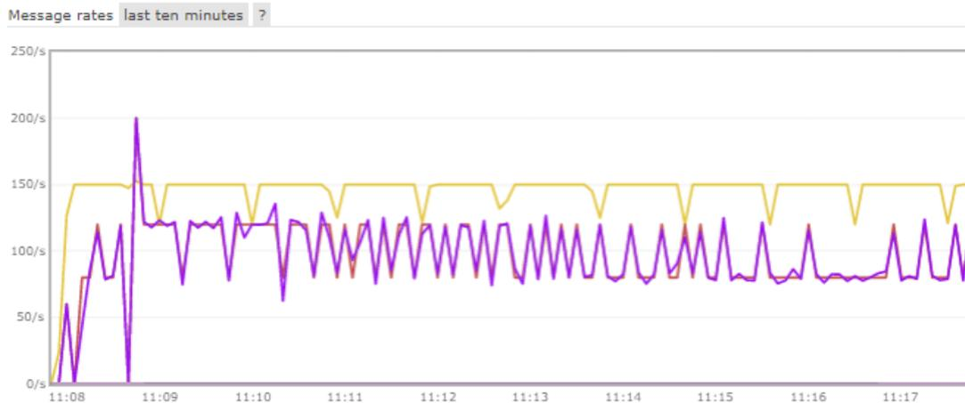
**Abbildung A.6.:** Ergebnis des Bandbreitentests für AMQP mit maximalen Nachrichtenstrom und manueller Bestätigung stellt die Nachrichtenrate des Publishers(gelb), die Bestätigungsrate des Consumers (lila), Rate des Bestätigungsversand(rot) dar. Ergebnisse über die 10 Minuten: durchschnittliche Rate von 97 Nachrichten/s.
