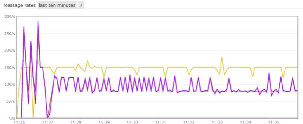
**Abbildung 4.4.:** Ergebnis des Bandbreitentests für AMQP mit heterogenem Nachrichtenstrom und manueller Bestätigung stellt den Verlauf der Nachrichtenrate des Publishers (gelb) und die Bestätigungsrate des Consumers (lila), Rate des Bestätigungsversand (rot) dar.
