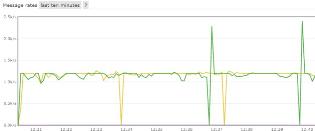
**Abbildung A.9.:** Ergebnis des Bandbreitentests für STOMP mit maximalen Nachrichtenstrom und automatischer Bestätigung stellt die Nachrichtenrate des Publishers(gelb), die Bestätigungsrate des Consumers (grün) dar. Ergebnisse über die 10 Minuten: durchschnittliche Rate von 1164 Nachrichten/s.
