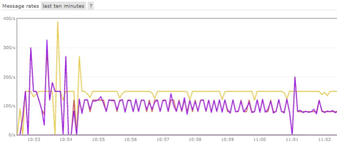
**Abbildung A.5.:** Ergebnis des Bandbreitentests für AMQP mit durchschnittlichen Nachrichtenstrom und manueller Bestätigung stellt die Nachrichtenrate des Publishers(gelb), die Bestätigungsrate des Consumers (lila), Rate des Bestätigungsversand(rot) dar. Ergebnisse über die 10 Minuten: durchschnittliche Rate von 97 Nachrichten/s.
