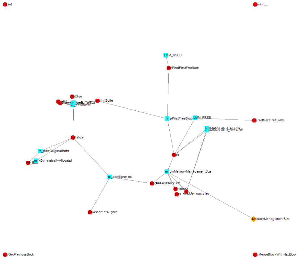
Abbildung 5.2: Die Grafik zeigt den Zusammenhangsgraphen einer Heap-Implementierung. Die Positionen der Knoten wurde mittels des Fruchterman-Reingold-Algorithmus berechnet.
